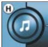
Efectuar pressões sucessivas na tecla **H** para aceder aos ajustes dos graves (**BASS**), dos agudos (**TREB**), do loudness (**LOUD**), do fader (**FAD**), do balanço (**BAL**) e da correcção automática do volume.
