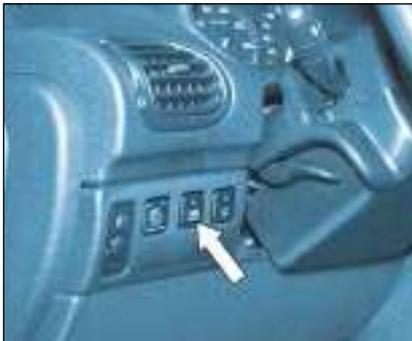
Este comando permite neutralizar o funcionamento dos vidros de trás em qualquer que seja a sua posição.
